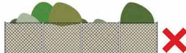
Áttört kerítések nádszövettel való zárása nem megfelelő
