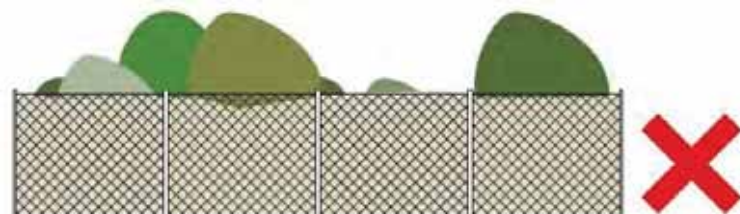
Áttört kerítések nádszövettel való zárása nem megfelelő
